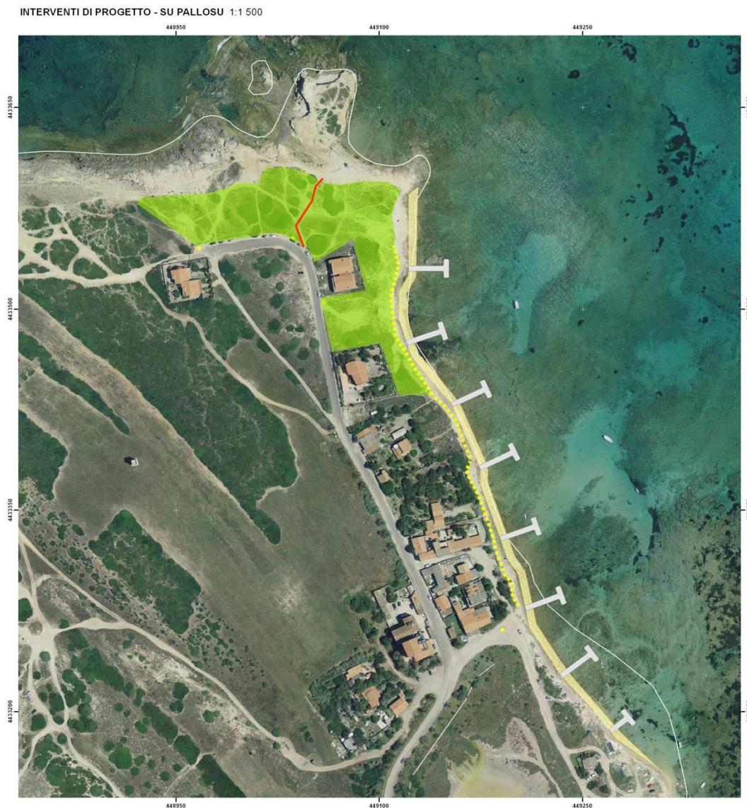
Figura 15 - Esempio di un intervento di ripascimento con opere di protezione
