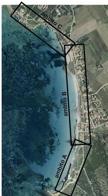
**Figura 4 - Individuazione degli ambiti di intervento per le opere per la fruizione in sicurezza della costa**
