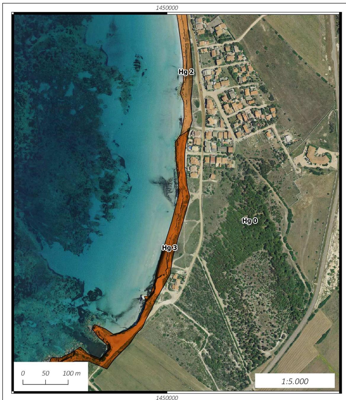
Figura 2 - Perimetrazione nel settore meridionale della costa, S'Arena Scoada. Per questa area gli interventi sono limitati al locale disaggio di elementi aggettanti e riprofilatura del ciglio della falesia.
