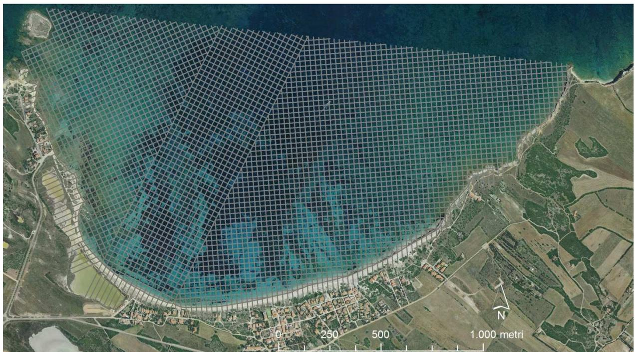
Figura 5 - Piano dei profili teorici da acquisire a mare mediante Single Beam: transetti trasversali e linee di controllo hanno spaziatura di 25m
